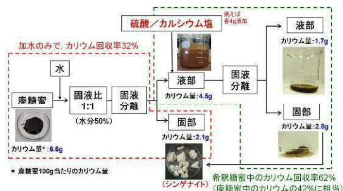
図2 廃糖蜜からカリウム回収実験フロー
