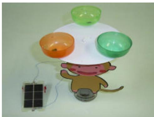
光電池に、当たる光の強さによって、回路に流れる電流の強さが変わり、モーターの回転の速さが変わることを実感させることができる。
