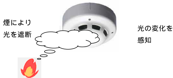
図3 煙感知器の原理
