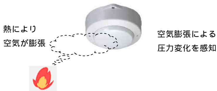
図2 熱感知器の原理
