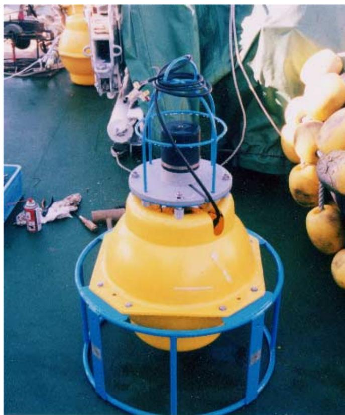
写真2 ガラス球を用いた低価格精密トランスポンダー
