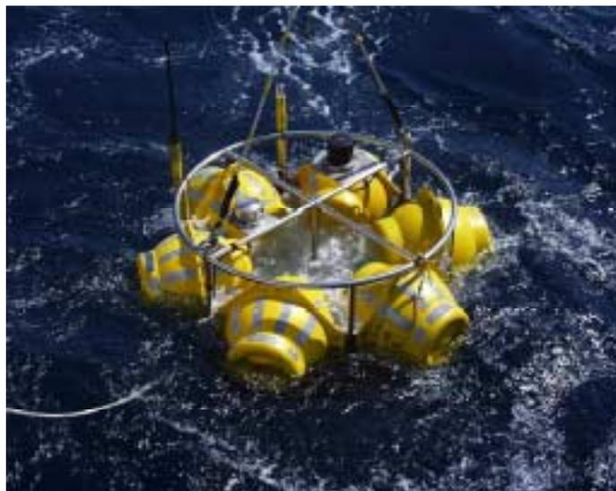
写真1 精密トランスポンダー。廻りのガラス球は、回収用のフロートとして機能する。
