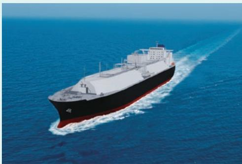
写真：SPBタンク方式大型LNG船
