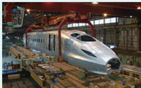
写真：E7 系新幹線製造の様子。
