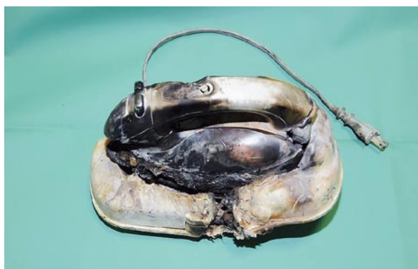
写真2 焼損した電気アイロンの状況
