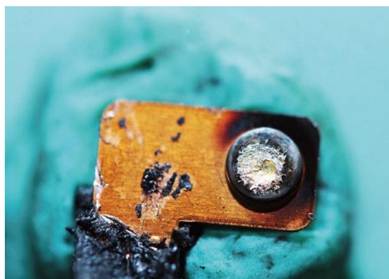
写真4 リレー接点の状況
