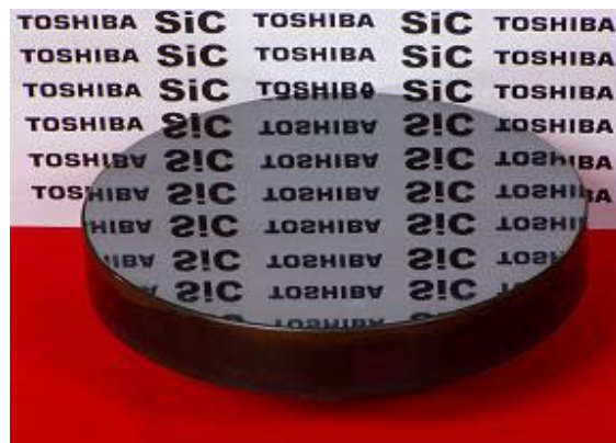
図2：鏡面研磨加工した高強度反応焼結SiCミラー
