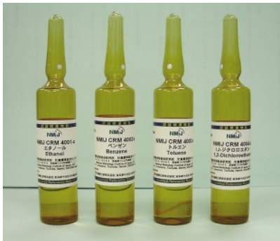
写真 NMIJ標準物質 VOC化合物およびエタノール
