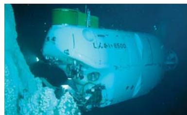
写真 2-5-18: 現在運航中の有人潜水調査船の中で世界一深く潜ることができる有人潜水調査船「しんかい 6500」(提供: 海洋研究開発機構)
