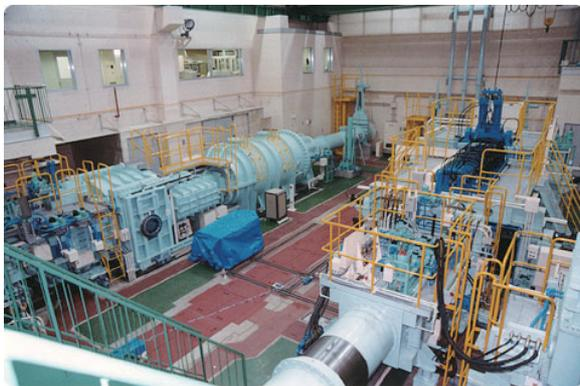
遷音速風洞（左）ならびに超音速風洞（右）
