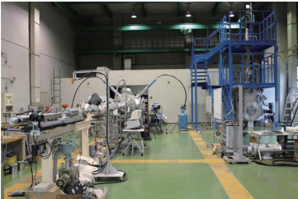
横型 2 段式軽ガス銃 (左) ならびに縦型 2 段式軽ガス銃 (右)
