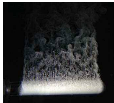
図1 SPGスパージャーにより生成したマイクロバブルの外観
