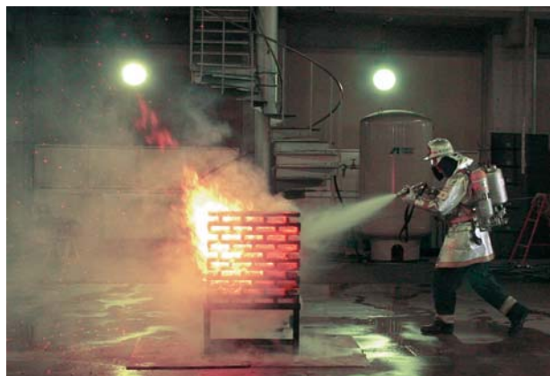
横浜市安全管理局による二流体混合噴霧消火システムの実験
