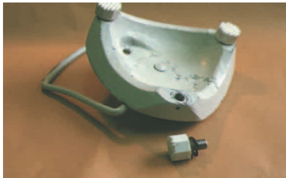
写真－6 標尺台下面のセラミックス爪
