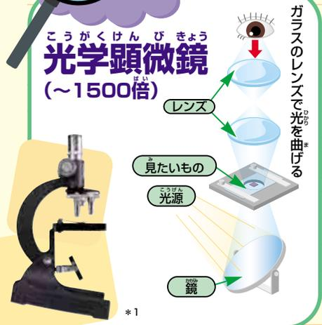
身近でふつうに使われている顕微鏡だ。ガラスのレンズで光を曲げて、大きく見せるよ。ただ、どんなに性能が良くても、光の性質で0.2μm(1万分の2mm)より小さいものは見られない。
