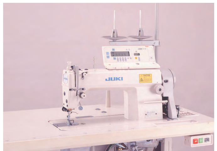
1996年11月 世界初の完全ドライヘッドシン DDL-5700N-7 (ドライヘッド高速1本針本縫自動糸切シン)
