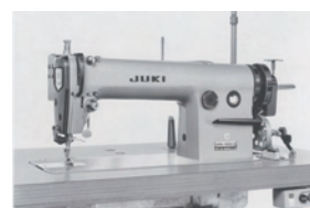
1969年2月に初 の糸切り機構を搭 載したDDL-555- 2 高速1本針本 縫自動糸切ミシン を発売。2006年N HK「プロジェクトX」 で紹介される
