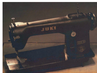
1953年3月 工業用ミシン1号機 DDW- 高速回転天秤 ミシンで工業用ミシン市 場に参入
