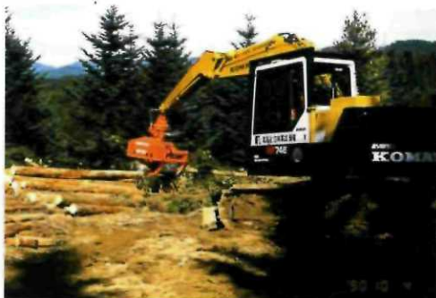
土場で作業中のプロセッサ
