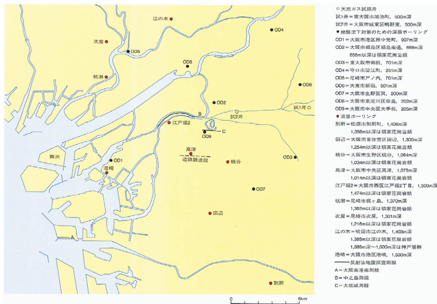
図1・1 - 大阪平野の天然ガス試掘井(試1井・試2井)、深層ボーリング(OD1~OD9)、主要な温泉ボーリングおよび反射法地震探査測線を示す図
