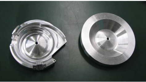
パーツフィーダボウルの加工前（右）と加工後（左）
