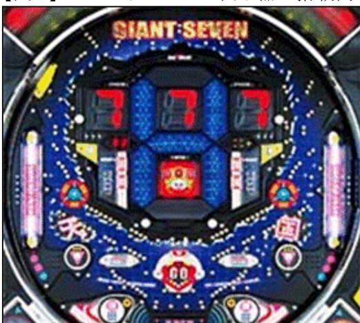
【図 2】 フルカラー 7セグ表示器の搭載例
