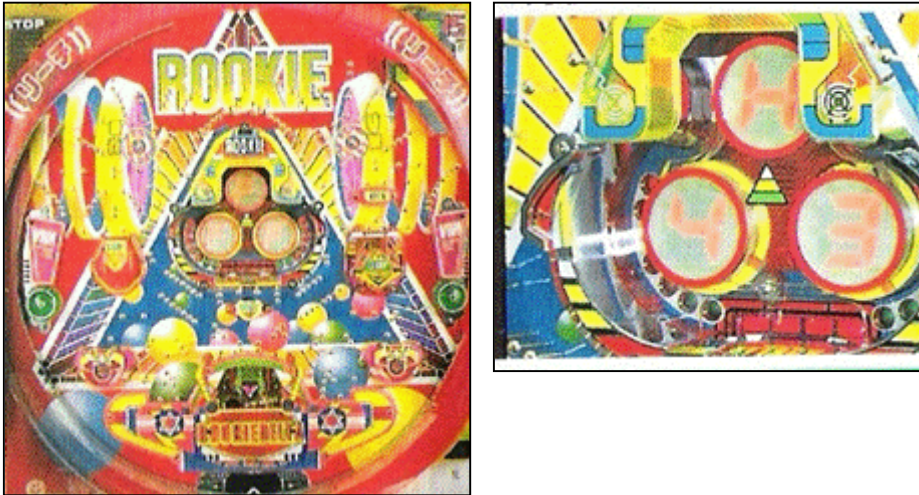
【図1】 7セグを三角形に配置した例
