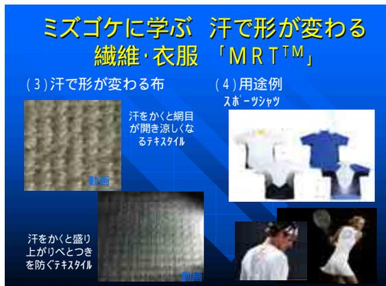
汗をかくと、網目が開いて汗が外に出ていく、あるいは、汗をかくと盛り上がり凸構造が出てきて、肌に触れる側に山がくる構造であれば、べとつかない。そういうスポーツウエアができ、テニスウエアとして製品化されている。
