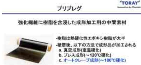
プリプレグは炭素繊維の束を数百本引きそろえ、未硬化のエポキシ樹脂を含浸し1m幅ぐらいのシート状にしたものである。プリプレグを所定幅のテープ状にして金属製のツールと呼ばれる型の上に積層した後、オートクレープ(圧力釜)の中で180程度に加熱し、樹脂を硬化させることにより、例えば航空機の翼の表面板(スキン)などを作ることができる。
