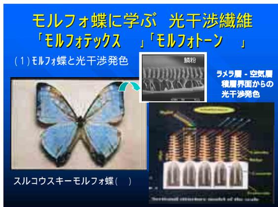
南米のモルフォ蝶は非常に綺麗なブルーに見えるが、実は材料は透明。透明なのに青く見える理由を探るため、この蝶々の表面を電子顕微鏡で観察した。すると樹木のような構造のものがずっとつながっていた。これはタンパク質でできているが、光干渉の原理で青く見えることがわかった。光が入ったときに、樹木状のタンパク質の屈折率と、空気の屈折率の差、それと非常に奇妙に干渉するような枝の厚み
