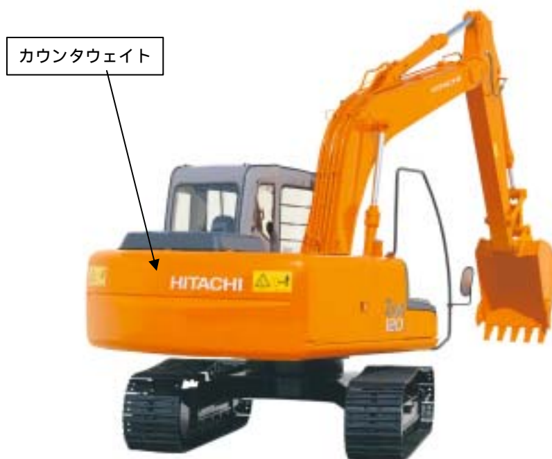
写真 1 油圧ショベル
