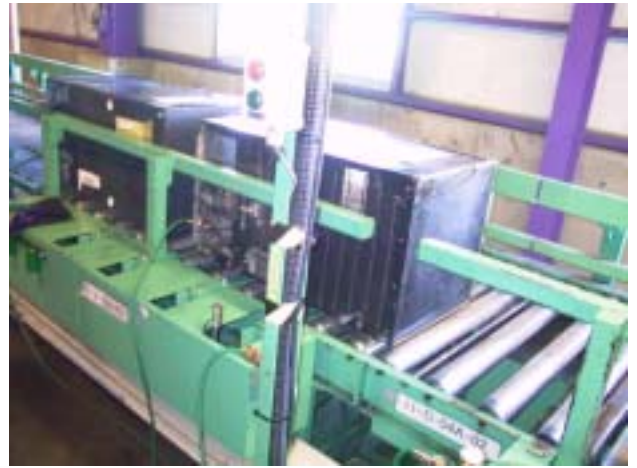
写真 2 冷蔵庫の冷媒フロン回収ラインと回収状況
