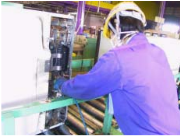
写真 2 冷蔵庫の冷媒フロン回収ラインと回収状況
