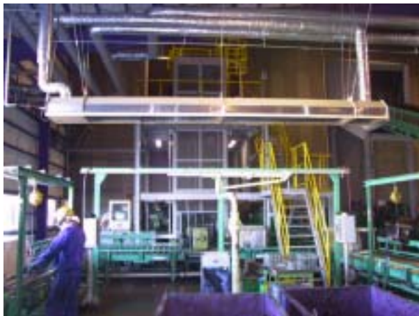
写真 3 冷蔵庫破砕機投入リフター合流部
