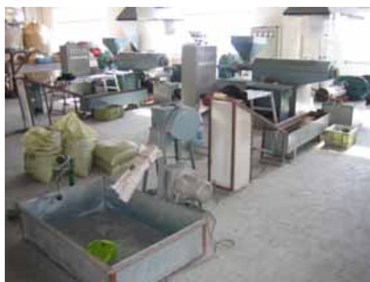
図2. 18 ペレット化設備
