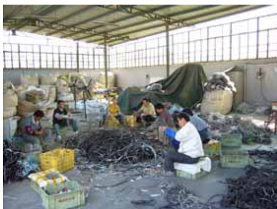
図2. 19 電線の解体、分別
