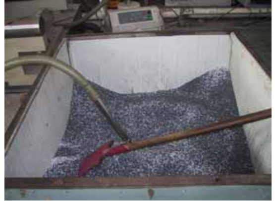
図 2. 2 2 原料投入 (廃プラスチック＋バージン材)
