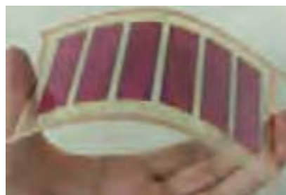
新原理の太陽電池(色素増感系太陽電池)の試作品 写真提供：物質・材料研究機構
