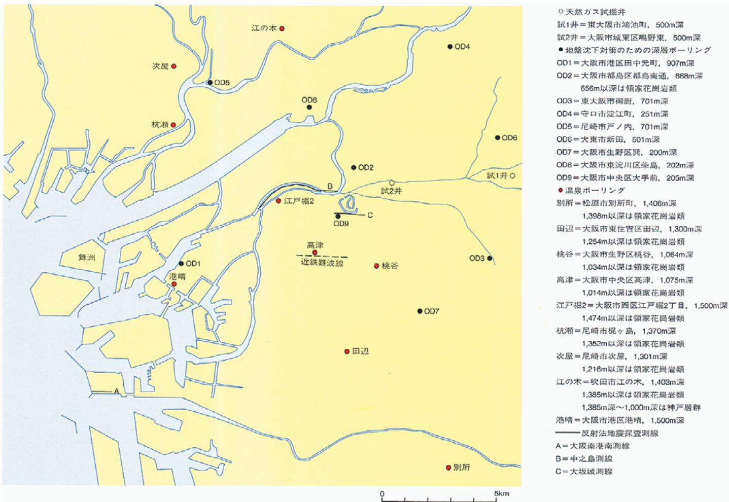
Cの大阪城測線では、約850m深の反射面が基盤との境とみなせます。図1・1で、上町上昇帯の基盤深度を北からみると、OD2が656m深、温泉ボーリングでは高津が1,014m深、桃谷が1,034m深で、北から南にむかって深くなっていきます。ほぼその中間にあるC測線の基盤深度が約850m深というのはいずれもです。
