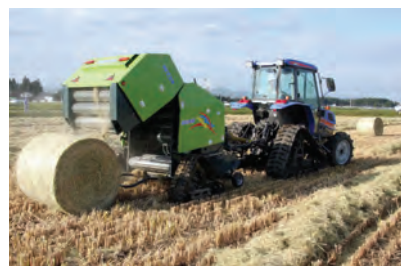
図4／クローラ型ロールベアによる梱包作業（現地試験）
