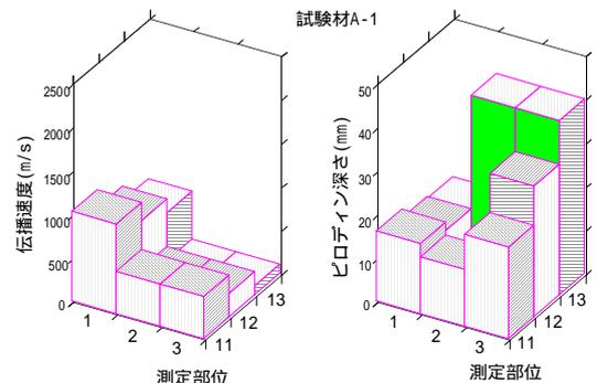
図5 材部位の劣化度推測結果
