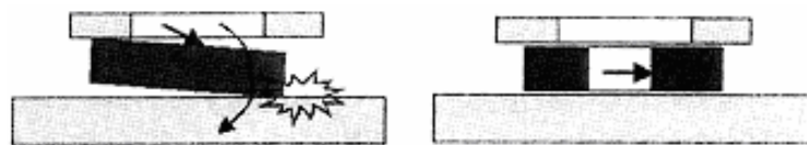
図4 駆動力の作用点の変更によるモーメントと局部面圧の低減
