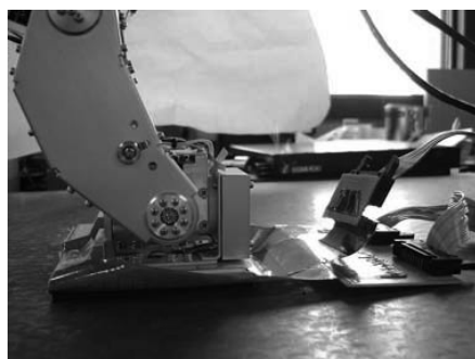
(a)ロボットの足と触覚センサの構成例
