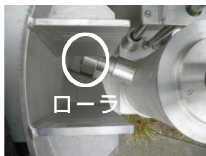
図4 ガイドピンに付けられたローラ
