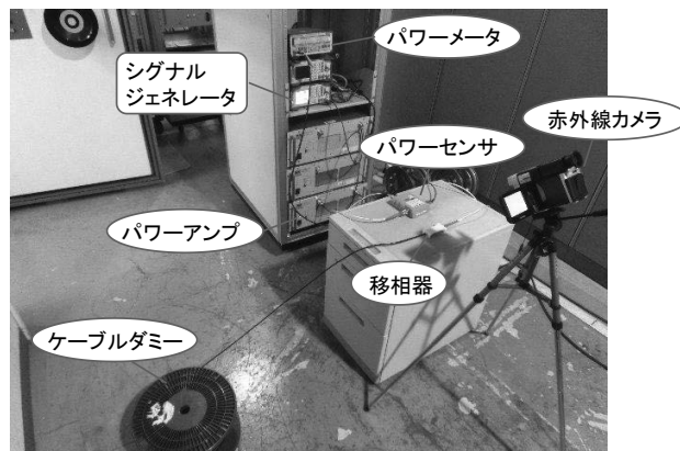
図 12 移相器の耐電力試験風景
