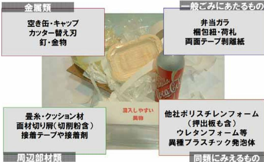
図 3.3.3 押出法ポリスチレンフォーム断熱材混入してはいけないものの分類と具体例
