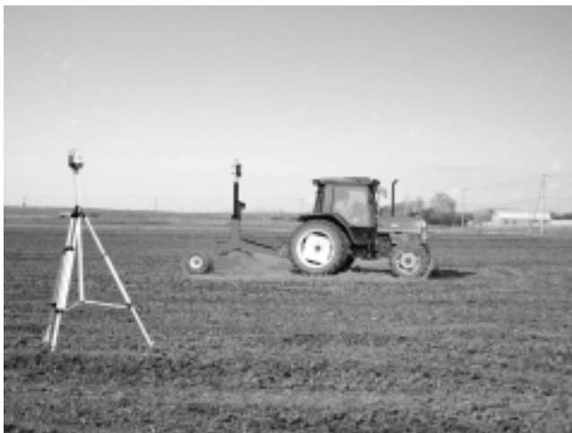
レーザー発光器、受光センサー、均平機本体
