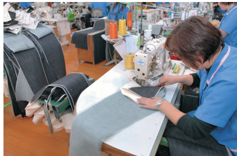
縫うにしたがって素材をくるとまわす。回しやすいように、テーブルを丸くカットした。
