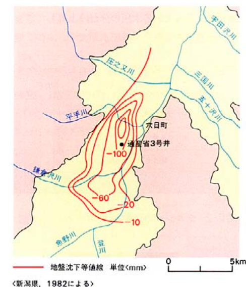
図1・9 - 新潟県六日町の地盤沈下(1975～1981)
