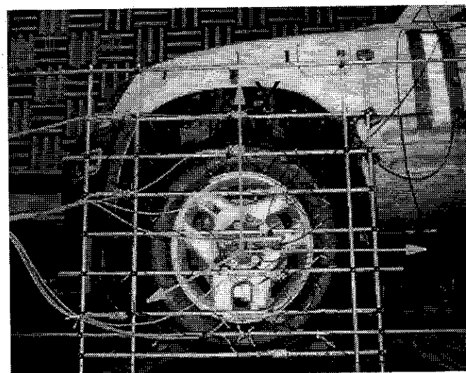
図30 音響ホログラフィ測定状況
