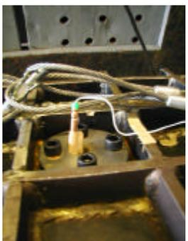
成形容器上部の孔から一部引き出しておいた導爆線に雷管をビニールテープで固定する。電気雷管は通電により発火し、そのエネルギーにより導爆線が起爆する。雷管は最小0.6Aの電流で発火するため、取り扱いには十分な注意が必要。
