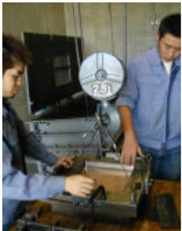
型、金属板、及び真空をひくためのビニールシートを下部容器に設置し、型押さえをボルトで締結する事により固定する。この行程が現行では手作業となるため効率化の点で見直しが求められる。(後ろに見るのが成形に用いた水槽)
