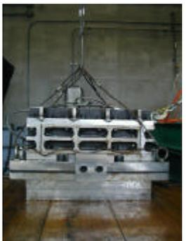
成型容器上部を下部の上に設置する。締結はしないので、上部は起爆時に上方に若干飛び上がる可能性がある。成形板上に落下する事の無いよう、下部にはガイドが設けられている。
