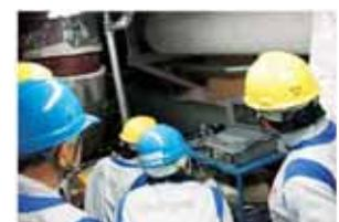
蒸気式空気抽出器の渦流探傷試験（青色のヘルメットが保安院検査官）
