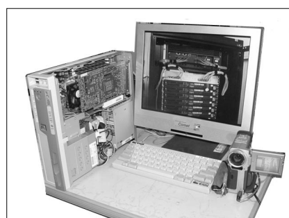
図7 実際の双方向会議システム構成例
