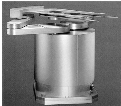
写真1 ガラス基板搬送ロボット
