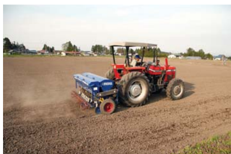
写真2：グレーンドリルによる播種 （条間19cm、作業幅2.5m）
