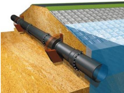
図4 柔構造底樋のイメージ図
