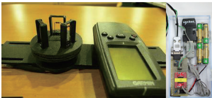
図 2 : (左) 風速・風向情報を検出する部分と GPS (右) センサ基盤
