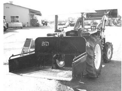
写真 トラクタに装着したトラクターダンプ
