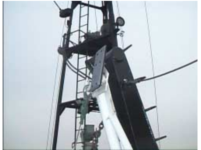
写真 4 改良後のクレードルヘッド
