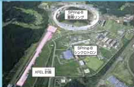
全長 140m のリニアック (線形加速器)、全周 396m のシンクロトロン (円形加速器) で電子を光速の 99.999998% まで加速する。加速した電子は全周 1436m の蓄積リングを回り続ける。蓄積リングに取りつけられたアンジュレーターによって、太陽光の 1 億倍に相当する明るさの放射光 (X線) を取り出すことができる。放射光は 0.1nm という、とても短い波長の X 線である。この波長は原子や分子と同程度またはそれ以下の長さであるため、波長をものさし代わりに、タンパク質の構造なども調べられる。
