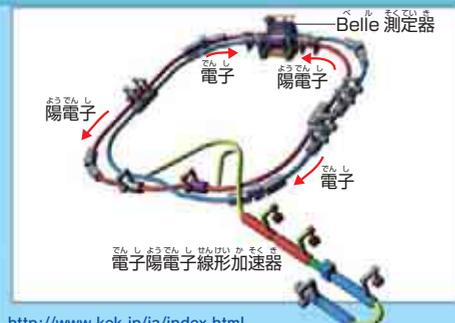
全周約 3000m の電子陽電子衝突型加速器 (Bファクトリー加速器) を用いて電子と陽電子を衝突させ、大量の B 中間子とその反粒子である反 B 中間子をつくり、測定器「Belle」にて、B 中間子と反 B 中間子の崩壊現象を精密に測定することにより、粒子と反粒子の物理法則の違いを明らかにする。
