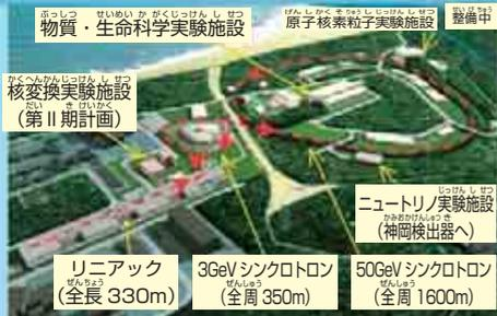
陽子を全長 330m のリニアック (線形加速器) と、全周 350m のシンクロトロン (円形加速器)、全周 1600m のシンクロトロンで光速の 99.98% まで加速する。この加速した陽子を標的となる原子核に衝突させて、原子核を壊す。そのときに発生する粒子 ( $\pi$  中間子、ミュオン、ニュートリノ、K 中間子、反陽子、中性子) を使って数々の研究をする。特に中性子ビームでは、その特性を生かし、生命科学の研究、新薬の開発、農業、環境を考えた技術の開発に応用が期待されている。
