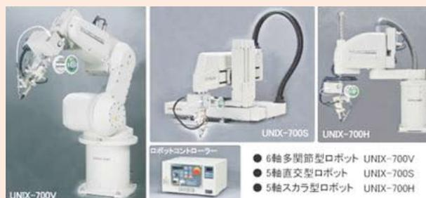
写真。ロボットはんだ付装置
