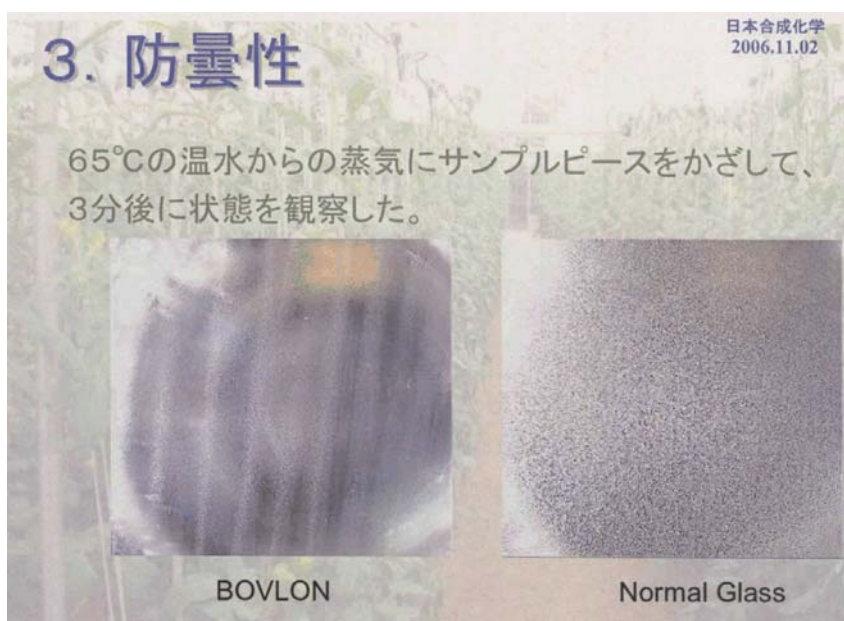
図1 二軸延伸PVOHフィルムの防曇効果
