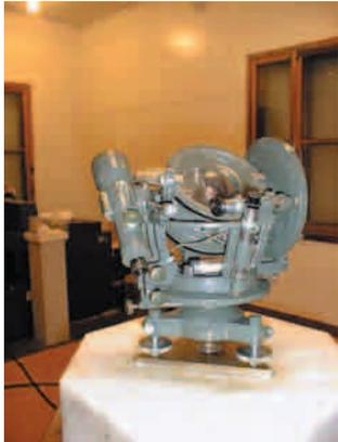
写真-26 GSI 型磁気儀
