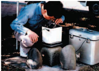
写真-24 ラコスト重力計による測定
