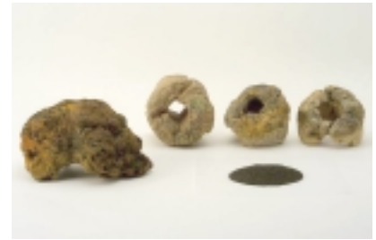
左：鉄滓 右奥：羽口 右手前：砂鉄
